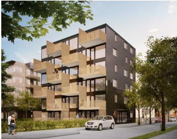
Bostadsprototyp 1.0 sammanbyggda till ett flerbostadshus i sex våningar. Fasaden är av solceller och balkongerna i småländskt trä. Flerbostadshuset passar i en urban miljö där behovet av snabba mindre lägenheter är stort. Illustration: Tengbom, ritning: NOOA
