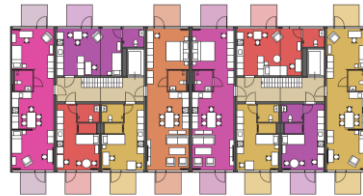
Bostadsprototyp 1.0 sammanbyggda till ett flerbostadshus i sex våningar. Fasaden är av solceller och balkongerna i småländskt trä. Flerbostadshuset passar i en urban miljö där behovet av snabba mindre lägenheter är stort. Illustration: Tengbom, ritning: NOOA
