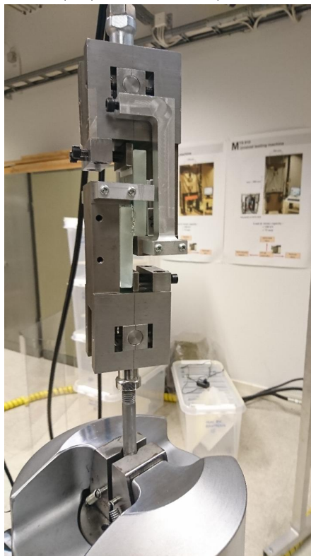
Bild 5 Detalj infästning av prover i dragprovningssutrustning
