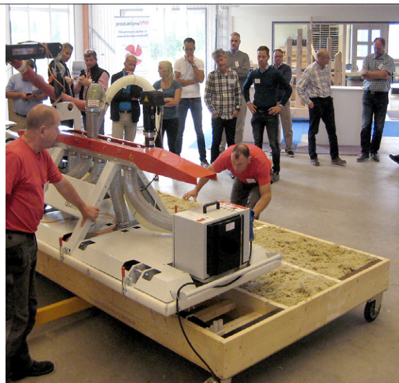
Här demonstreras den nya tekniken för automatiserad inblåsning på Träcentrum i Nässjö. Foto: Kalle Persson.
