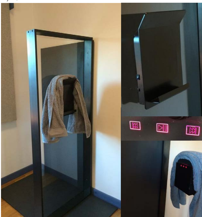
Figur 4. Prototyp – "Integrerat ljud i duschvägg". Bild till vänster visar prototyp i helhet, med en handduk över för att visa att den lilla lådan med elektronikboxen också kan användas som handdukstork. Till höger högst upp visas elektronikboxen i helhet där man ser on/off-knapp och uttag för batteriladdare. Till höger längst ner ser man hur det ser ut inifrån duschen, de röda touchknapparna är förstora i bilden ovanför. Foto: Lina Grund Bäck SP – Glas.
