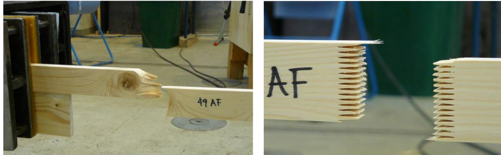
Figur 13. Defekteliminering i sidbräder genom fingerskarvning.
