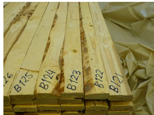
Figur 7. Utseendesorterade sidbräder av VI-sort eller bättre; för urval av sidbräder med vankant.
