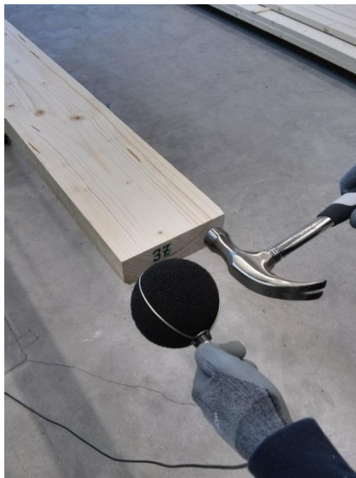
Figur 9. Excitering av axiella vibrationer i ett virkesstycke med hammarslag, samt insamling av virkesstyckets grundton och övertoner med mikrofon.
