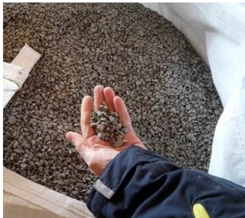
Figur 23. Stegljudisolering på CLT-bjälklag: a) bjälklagsuppbyggnad, b) grusmaterial som sprids ovanpå CLT-bjälklag, och c) spridning av grusmaterial med hjälp av "blåsning".
