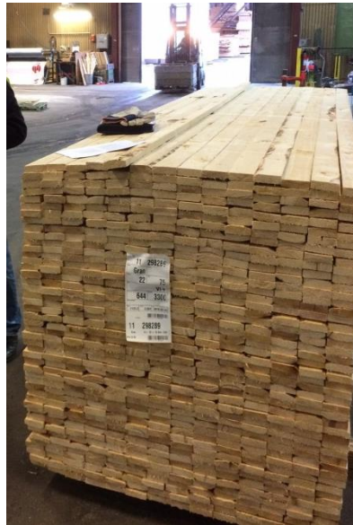
Figur 7. Utseendesorterade sidbräder av VI-sort eller bättre; för urval av sidbräder med vankant.
