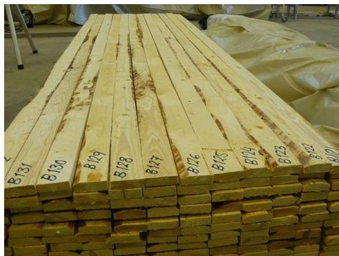
Figur 7. Utseendesorterade sidbräder av VI-sort eller bättre; för urval av sidbräder med vankant.
