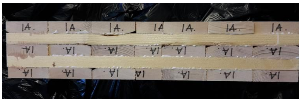
Figur 18. Provkropp av Typ 1, tillverkad av lameller som valts ut för att uppnå maximal mängd och storlek på vankanter.
