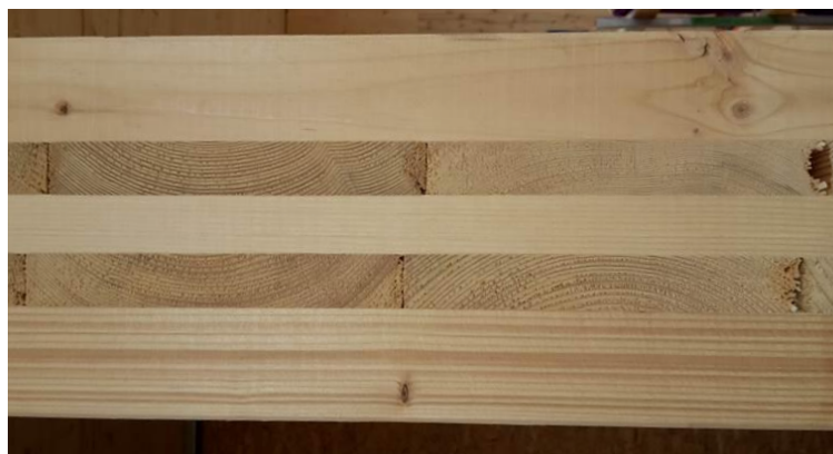
Figur 1. CLT-skivor bestående av tre skikt sidobräder och två skikt centrumutbyte: a) sidobräder i ytskikt och mitskikt, b) sidobräder i de tre inre skikten.
