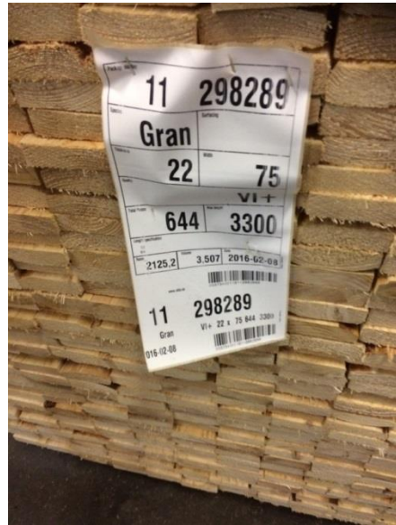
Figur 7. Utseendesorterade sidbräder av VI-sort eller bättre; för urval av sidbräder med vankant.
