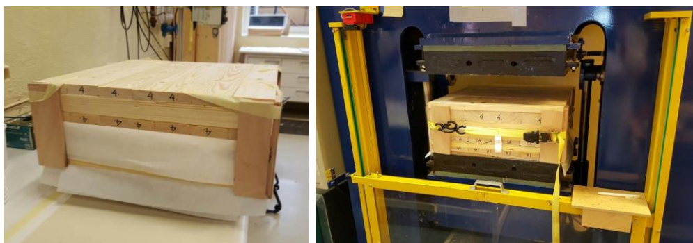
Figur 17. a) Provkroppar förberedda för pressning, och b) provkroppar placerade i laboratorielimpress (Foto Dynea AS).
