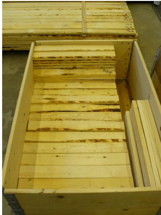
Figur 16. Paketering av sågade lameller för leverans till Dyneas laboratorium i Lilleström, Norge, för limning och pressning av CLT-provkroppar.
