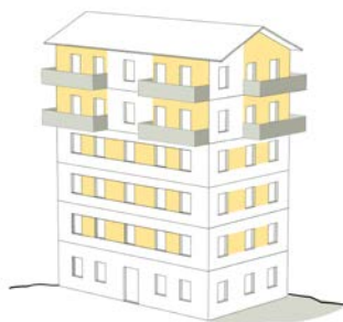
Figur 8. Exempel på tillåten placering av träfasad. Kombination av brutet fasad och skydd mot brandspridning med balkonger.
