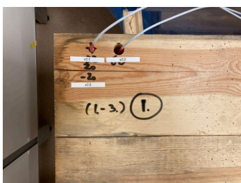
Fuktkvoten i position 1 i ett hörn av KL-elementet.
