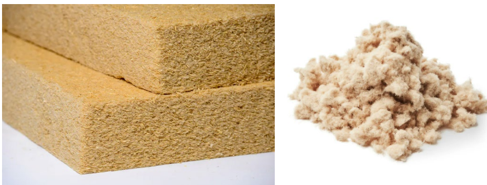
Figur 2. Träfiberisolering i skivformat till vänster och lösullsformat till höger. (Hunton, 2022, Produkter-arkiv - Hunton Sverige )
