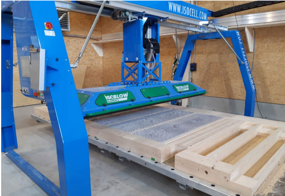
Figur 1. ISOBLow portal med inblåsningsskiva för isolering av fack i planelement. (Isocell, 2022, WERBUNG MA ELEMENTS 4 SV.pdf (isocell.com) )
