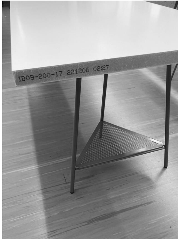
Figur 12. Bord byggt av innerdörr, med kommersiellt tillgängliga ben. På kortsidan av bordsskivan syns en intern märkning från produktionsprocessen. Foto: David Eklöf.
