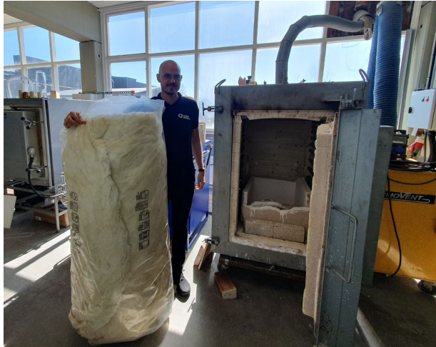
Figur 4. Ohärdad glasull, Ola Karlsson från Climate Recovery, samt ugn på The Glass Factory för att avlägsna bindemedlet.
