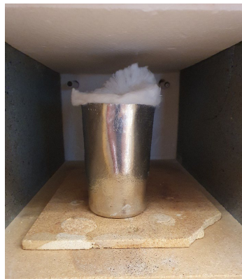
Figur 3. Degel (Ø50mm Ø60mm h90 mm) med glasull efter att bindemedlet tagits bort genom upphettning.
