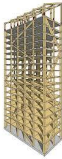
Figur 10 Exempel på Pelare-Balk stomme
